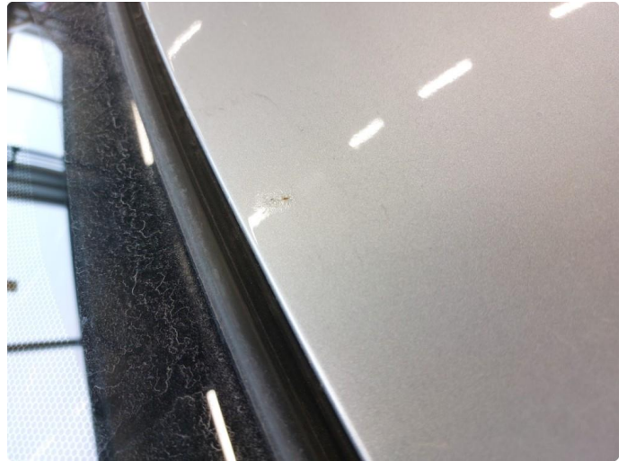
1.2 Steinsprut med rust
