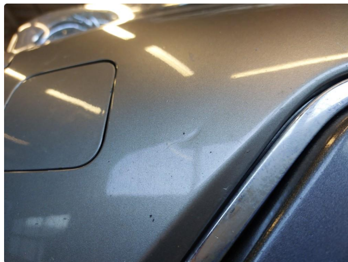
1.7 Ripe(r) ned til grunning
