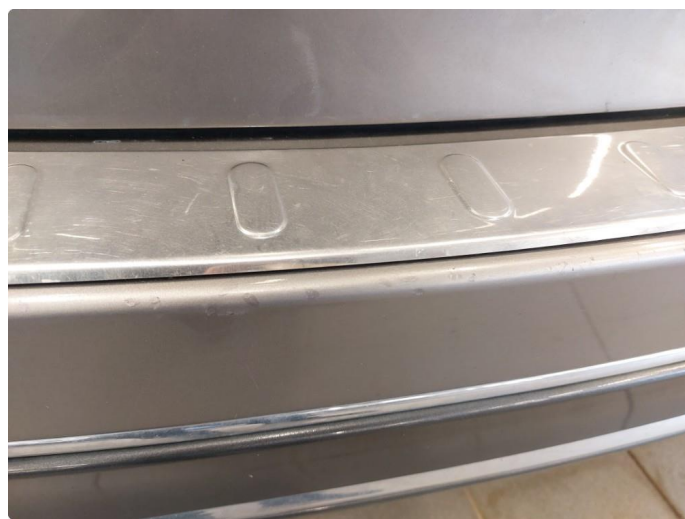
1.7 Ripe(r) ned til grunning
