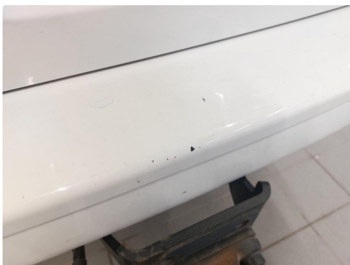
1.1 Noen riper og småbulker
