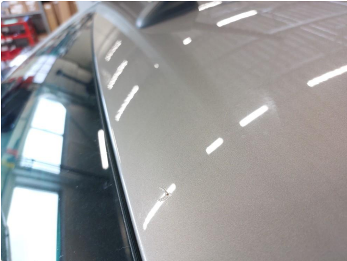
1.1 Steinsprut med rust
