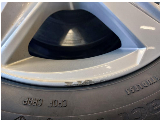
1.1 Skade på felg
