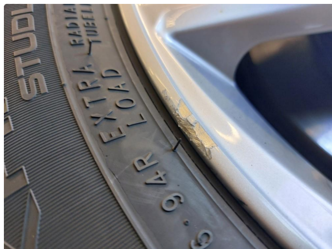
1.1 Skade på felg
