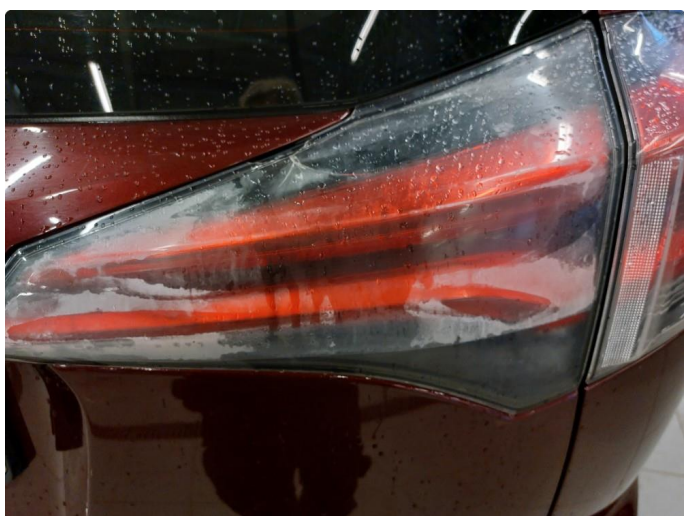
2.1 Defekt / sprukket glass
