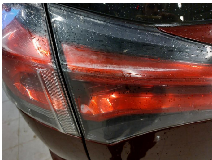
2.1 Defekt / sprukket glass
