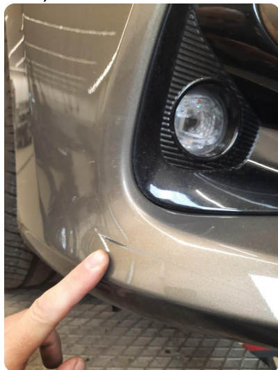
1.2 Ripe(r) ned til grunning Smart repair. høyre fanger foran også en ripe lenger opp på fanger høyre side
