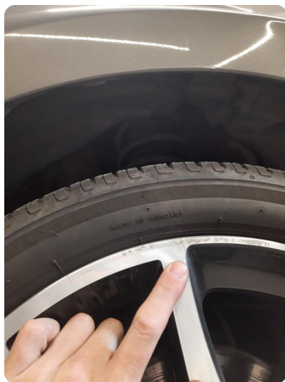
1.1 Kantkjørt felg Kantkjørt sommerfelg x2 en er normalt, den andre vurderes for repp
