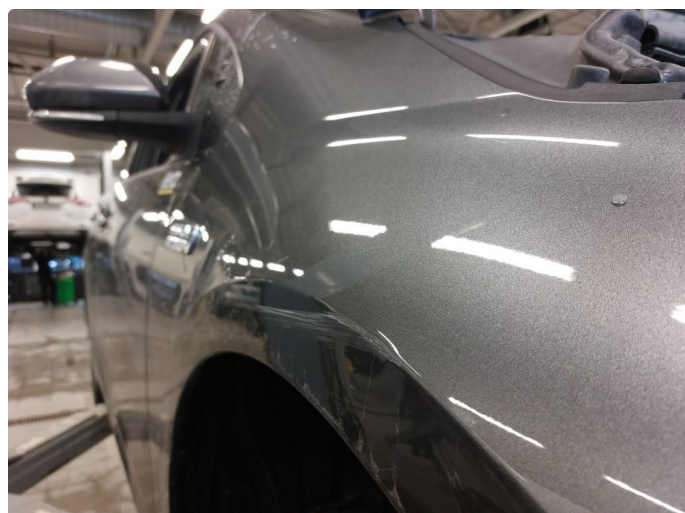
1.3 Bulk med lakkskade
