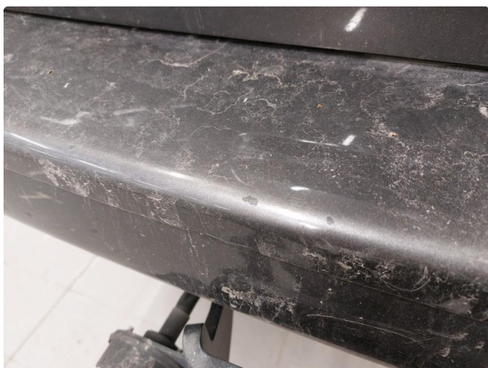
1.1 Noen riper og småbulker
