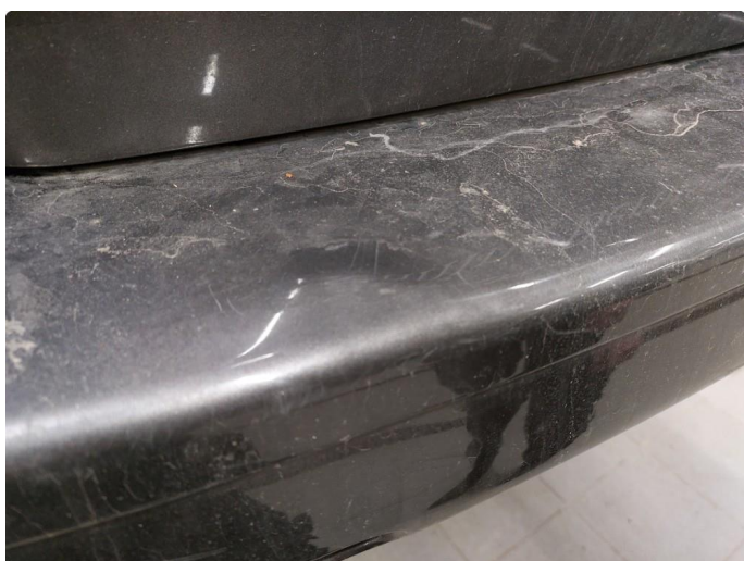
1.1 Noen riper og småbulker
