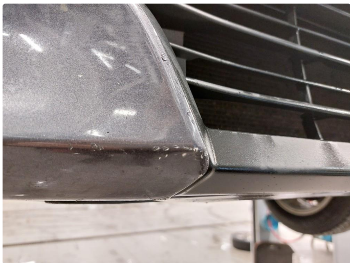
1.4 Små skrubbskader underkant
