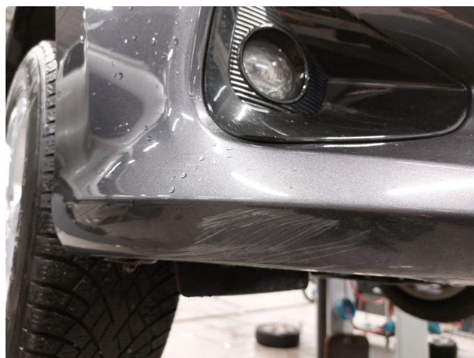
1.4 Små skrubbskader underkant
