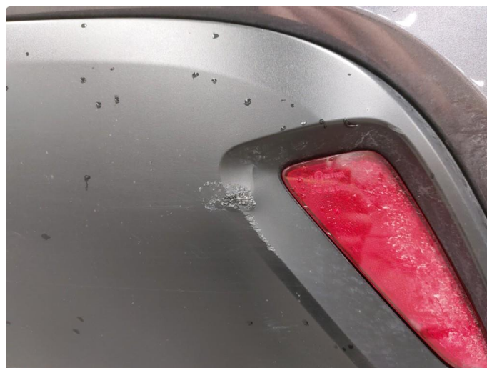
1.4 Små skrubbskader underkant
