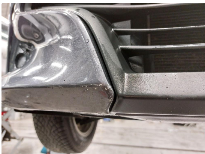
1.4 Små skrubbskader underkant
