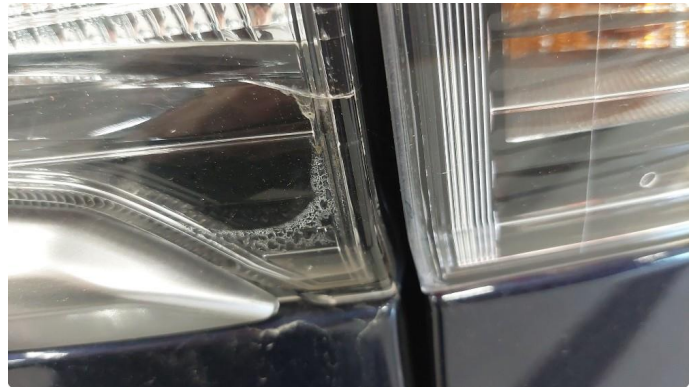
2.1 Defekt / sprukket glass
