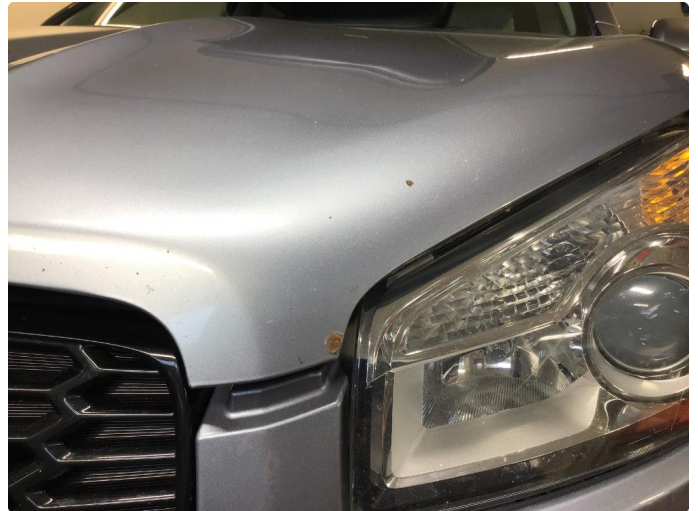
1.2 Noe steinsprut med rust
