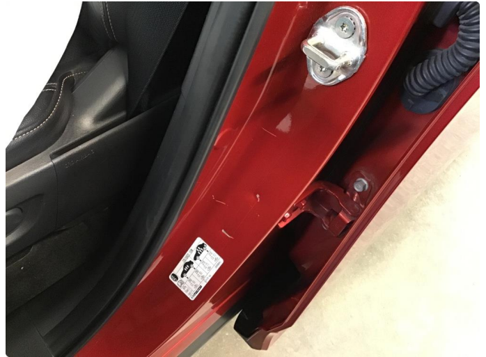
1.2 Bulk med lakkskade
