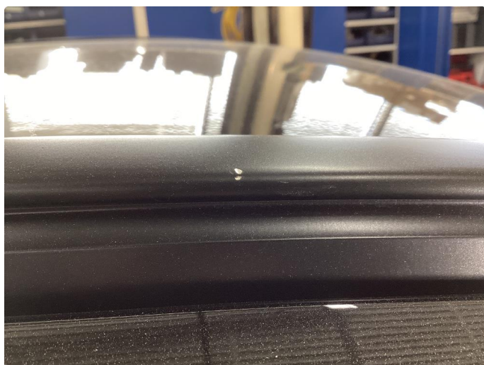
1.4 Liten skade etter bruk av takstativ
