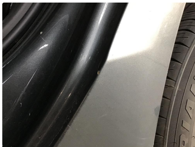
1.5 Steinsprut med rust
