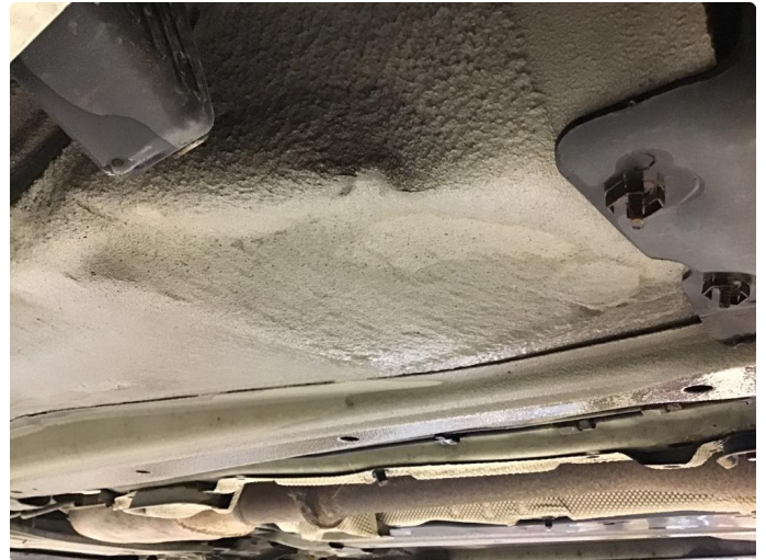
1.1 Skade/bulk i gulv ved jekkfeste venstre bak
