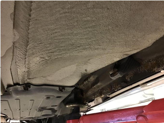
1.1 Skade/bulk i gulv ved jekkfeste venstre bak
