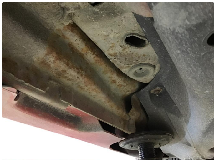
1.1 Noe overflaterust på underside
