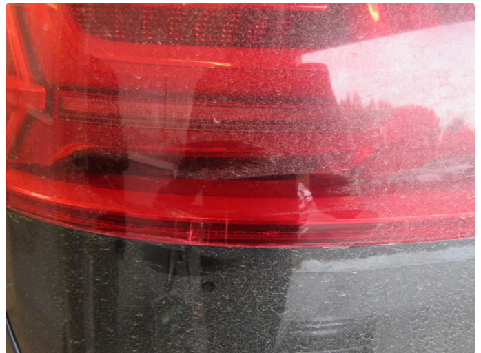
2.1 Sprekkdannelser baklykt venstre bak
