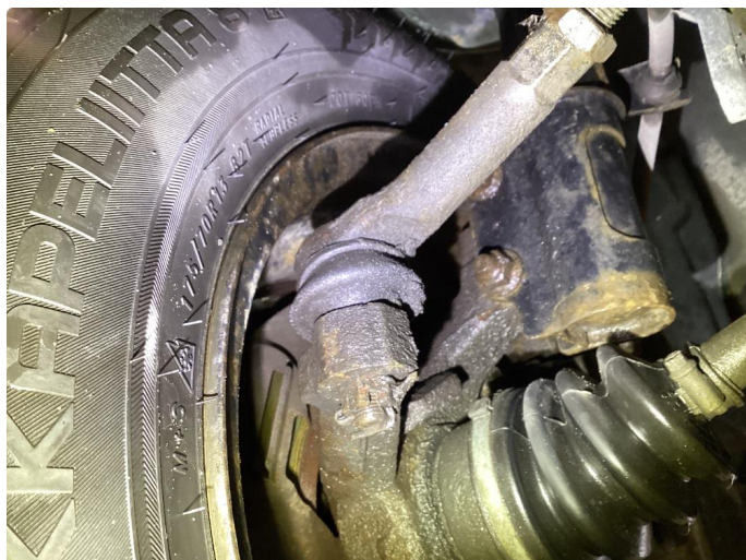
3.1 Mansjett på styring defekt
