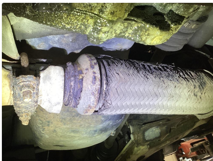
2.1 Skade på flexirør
