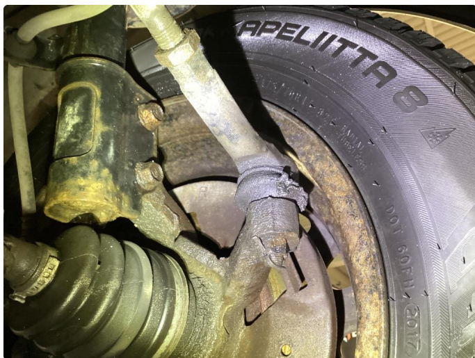
3.1 Mansjett på styring defekt
