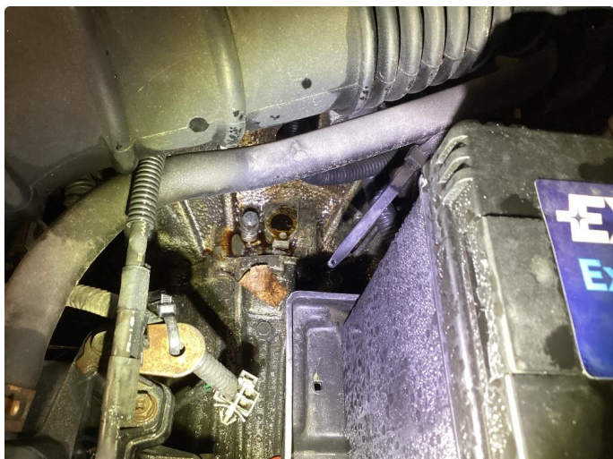
2.2 Oljelekkasje fra motor
