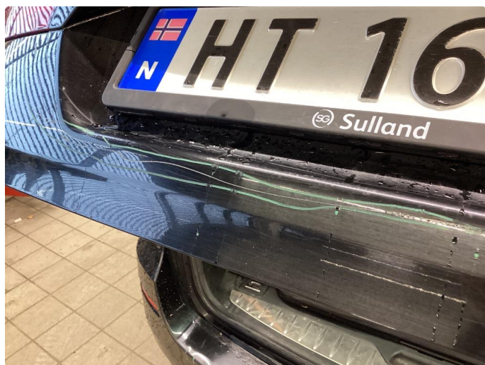
1.2 Ripe(r) ned til grunning
