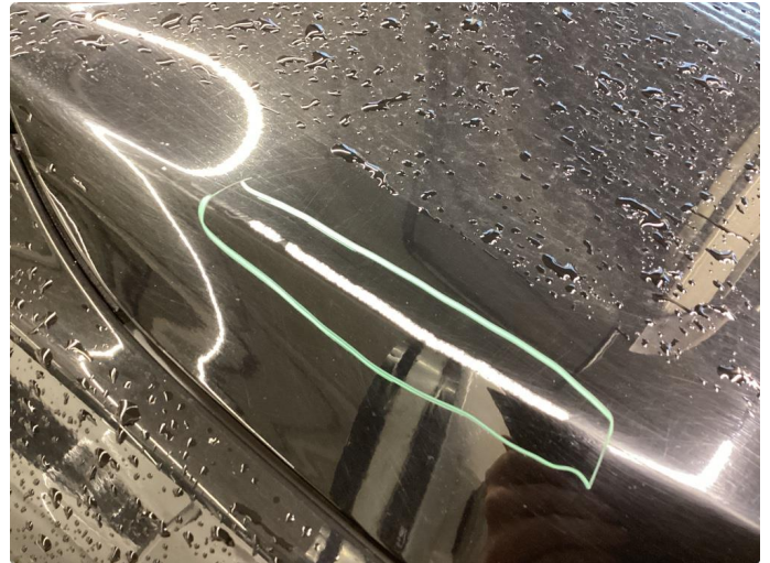
1.1 Ripe(r) ned til grunning
