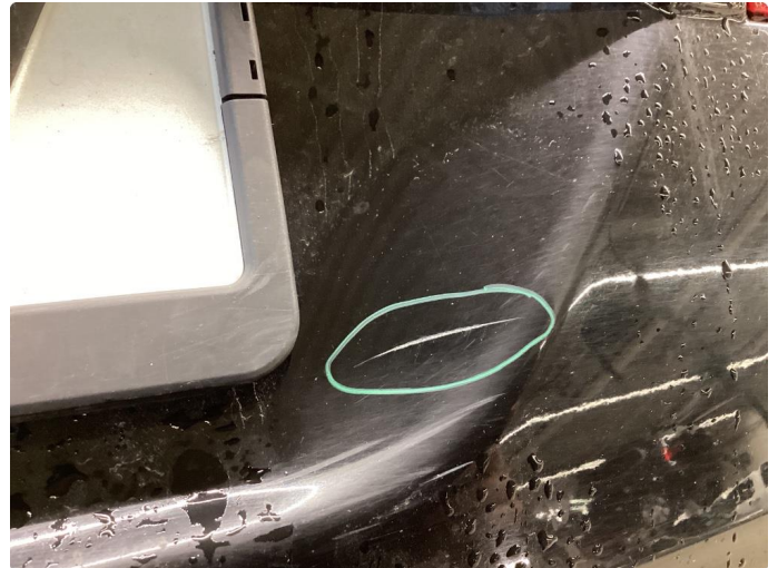
1.2 Ripe(r) ned til grunning
