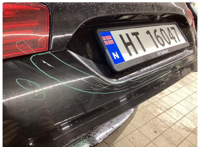
1.2 Ripe(r) ned til grunning
