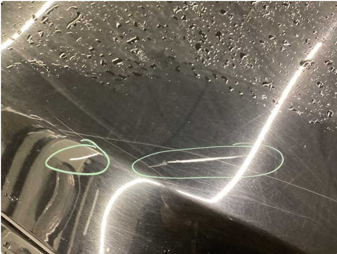
1.1 Ripe(r) ned til grunning
