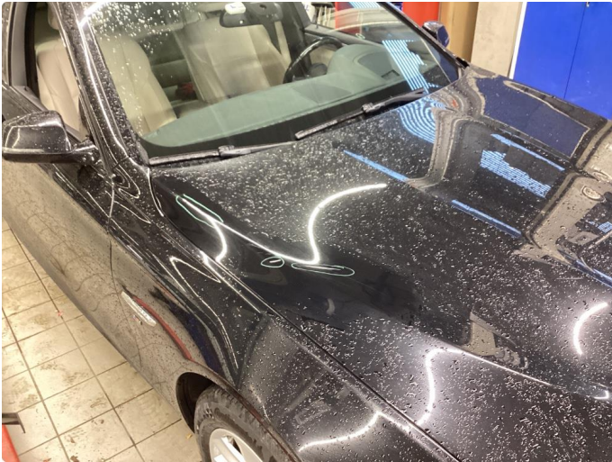
1.1 Ripe(r) ned til grunning
