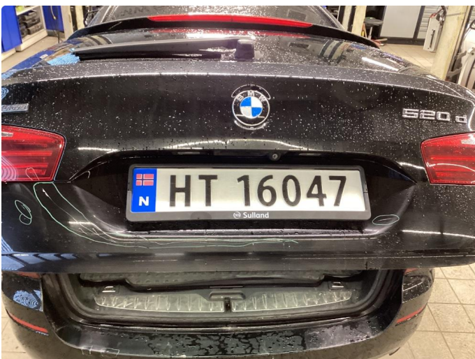
1.2 Ripe(r) ned til grunning
