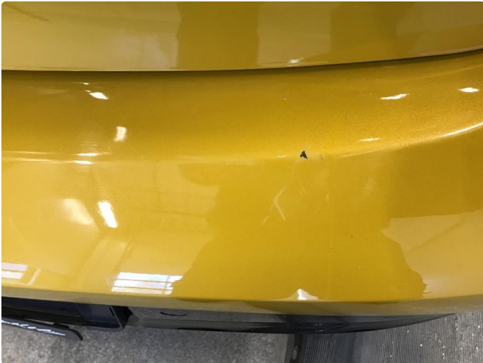
1.1 Ripe(r) ned til grunning
