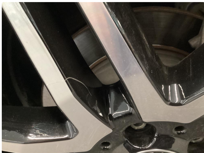
1.3 Skade på felg
