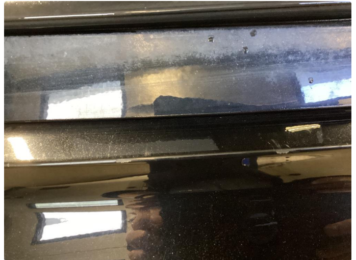
1.3 Ripe(r) ned til grunning
