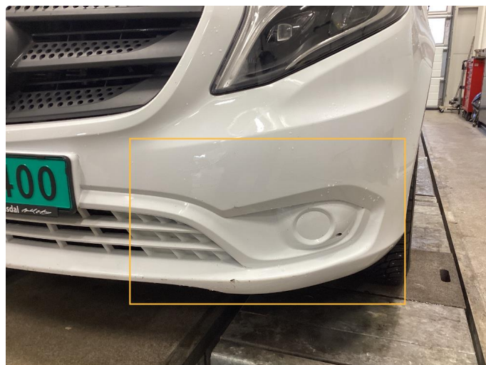
1.2 Ripe(r) ned til grunning
