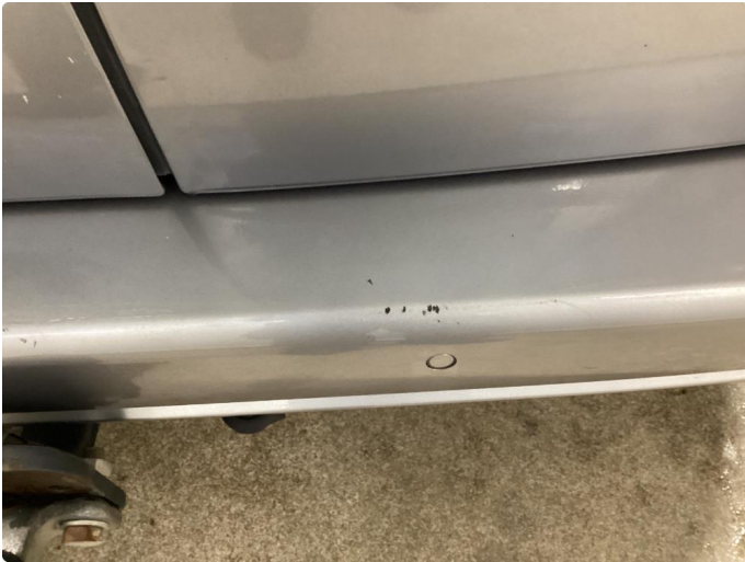
1.4 Ripe(r) ned til grunning
