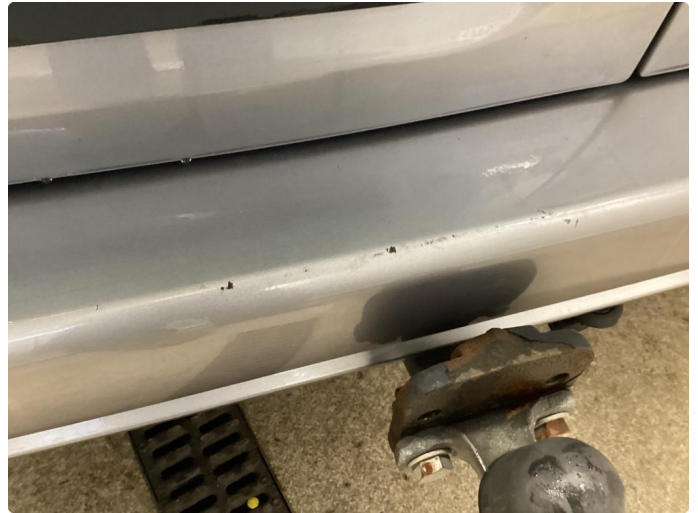
1.4 Ripe(r) ned til grunning
