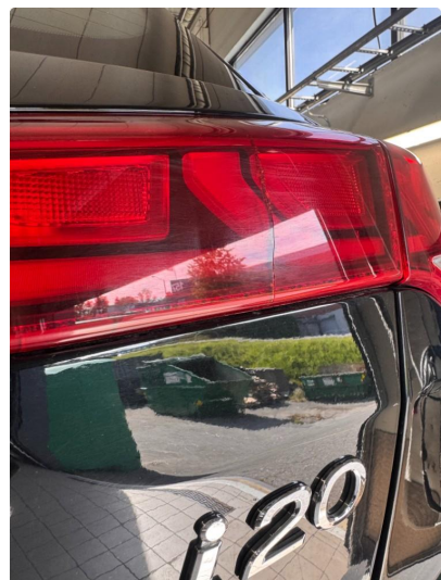
2.1 Defekt / sprukket glass
