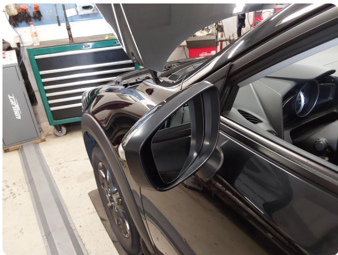
1.2 Defekt innfelling Defekt innfelling venstre speil
