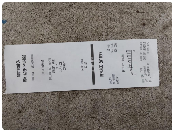
3.1 Dårlig kapasitet 12v batteri tester dårlig kapasitet
