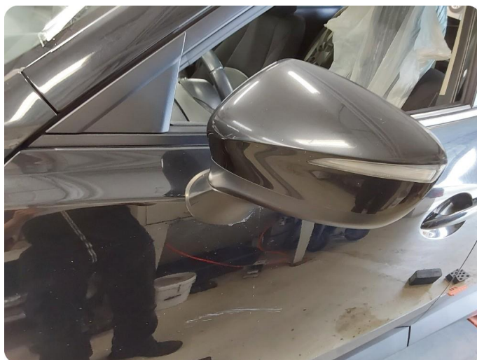
1.2 Defekt innfelling Defekt innfelling venstre speil
