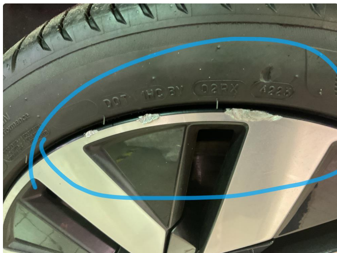
1.8 Skade på felg
