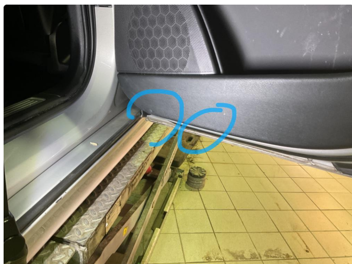
4.1 Skadet/merker etter utstyr
