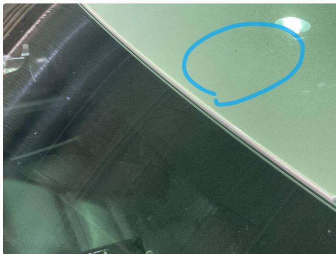
1.11 Steinsprut med rust
