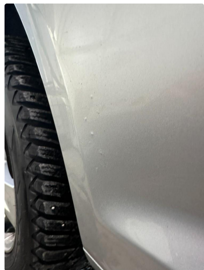
1.3 Steinsprut med rust
