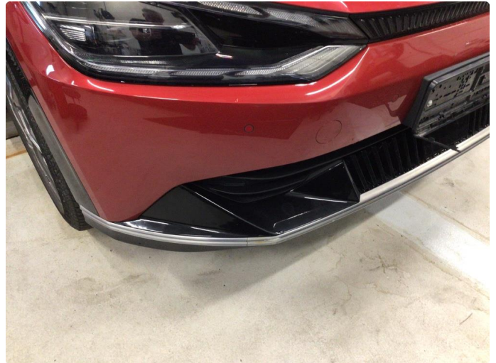
1.1 Liten skade i pyntelist foran.
