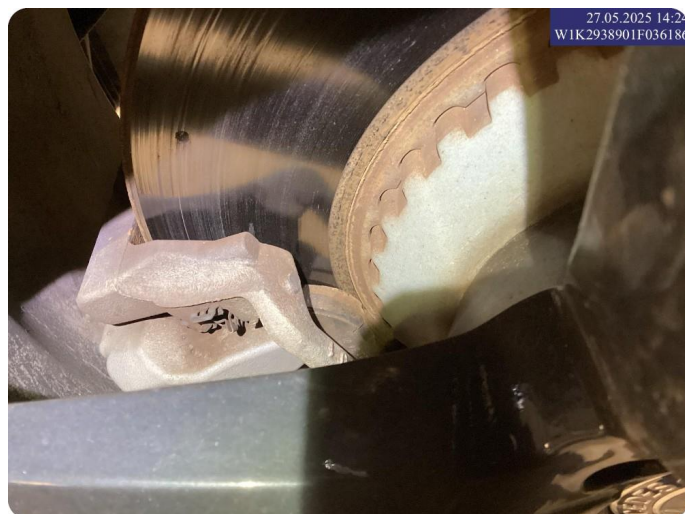
3.1 Utslitte skiver og klosser Slitte bremseskiver og rust innside bremseskiver bak
