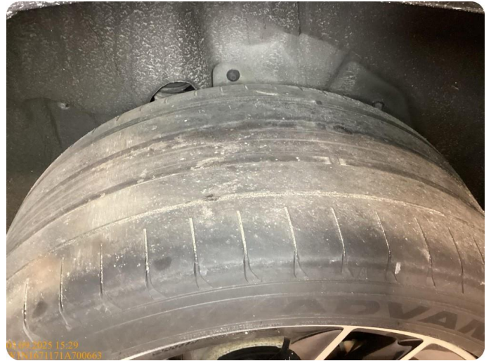
1.2 For lite mønsterdybde sommerdekk 2 stk Dekk bak er blankslitt.
