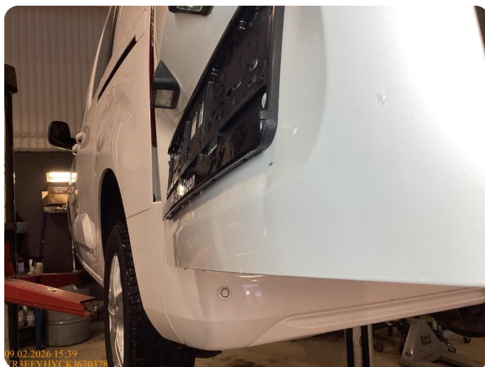
1.8 Noen bulker med lakkskader Bulk venstre bakdør
