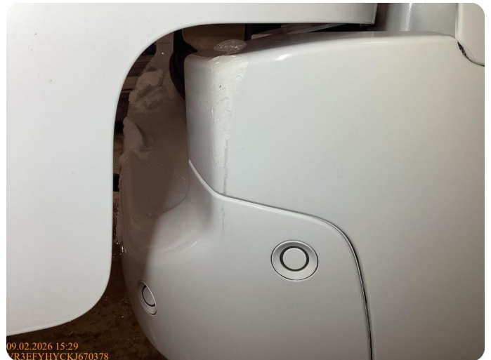
1.4 Fargeavvik Flekkklakk bakfanger høyre side
