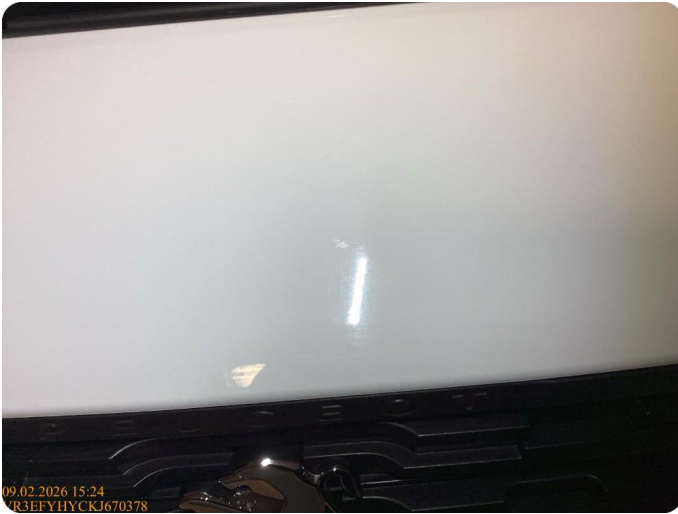
1.1 Stensprut Flere flekkklakkerte steinsprut panser og frontfanger
