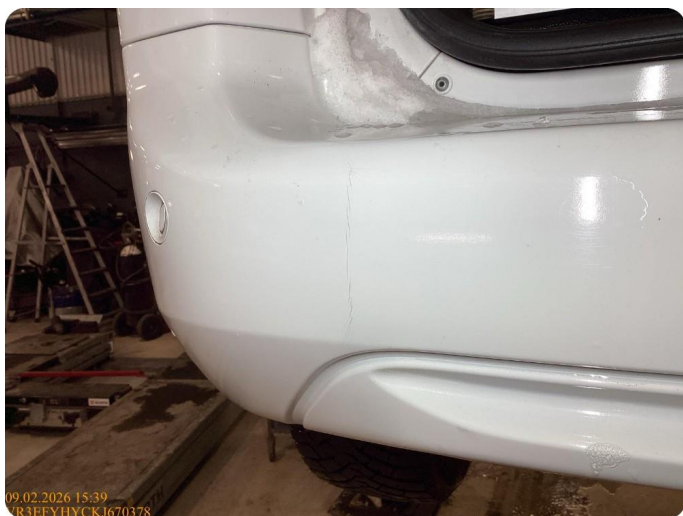
1.7 Øvrige feil Sprekker i bakfanger
