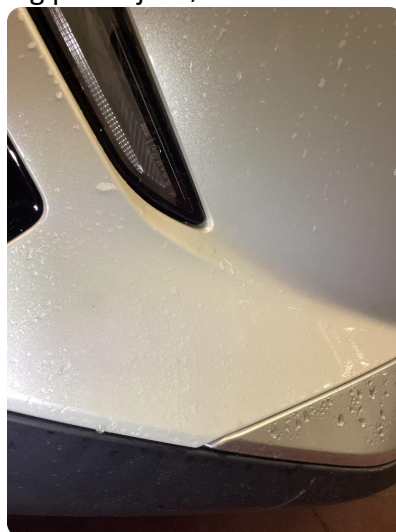
1.6 Steinsprut Flere små steinsprut på høyre side av frontfanger
