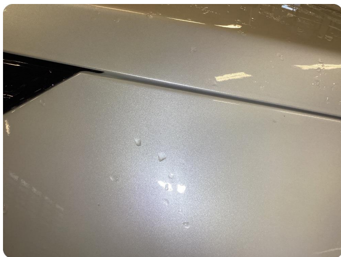
1.2 Steinsprut Flere små steinsprut framskjerm vs
