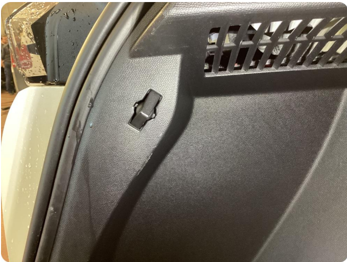
2.2 Ripe(r) Slitasje riper på deksler i bagasjerom
