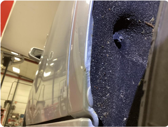
1.1 Noe korrosjon/rust Steinsprut med korrosjon hjulbue venstre bak. Noe begynnende korrosjon hjulbue venstre bak fremkant
