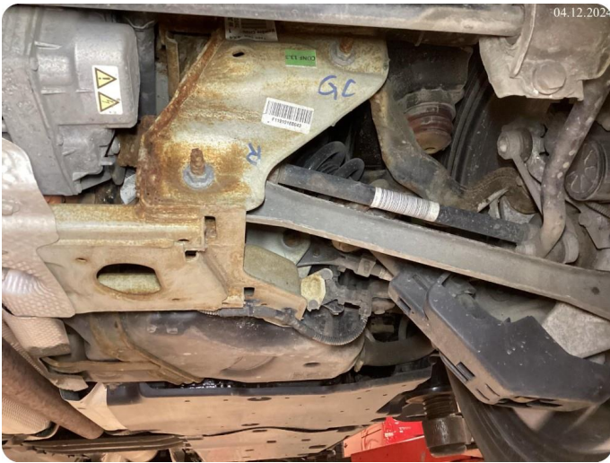
1.1 Rust Noe rust under bil. Anbefaler unnderstellsbehandling.
