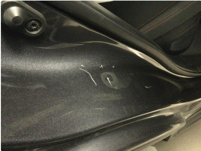
1.1 Noen riper og småbulker
