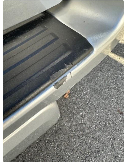
1.1 Noen lakkskader bakfanger.
