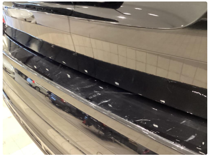
1.4 Ripe ved innlastning - Lagt på beskyttelse folie
