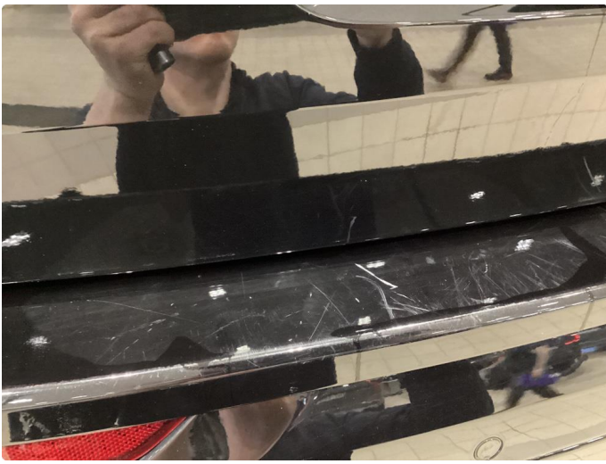
1.4 Ripe ved innlastning - Lagt på beskyttelse folie
