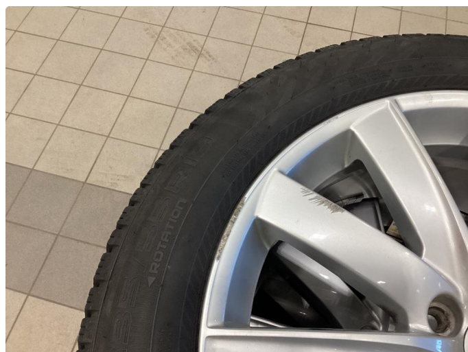
1.4 Par skader langs kanten på vinterfelger
