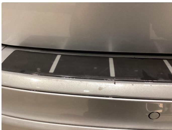
1.8 Skrap ved innlastning
