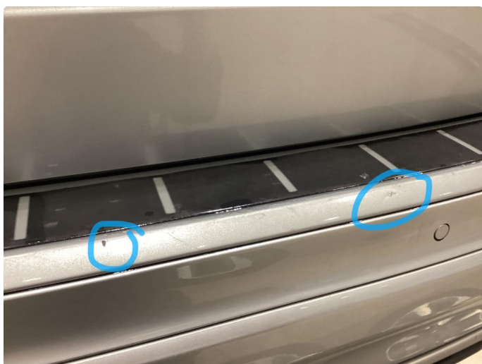
1.8 Skrap ved innlastning
