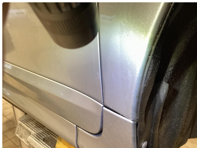
1.1 Rust - Rust fjernet og lakkert
