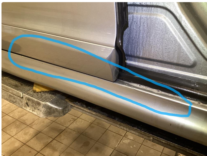
1.11 Reparert og lakkert
