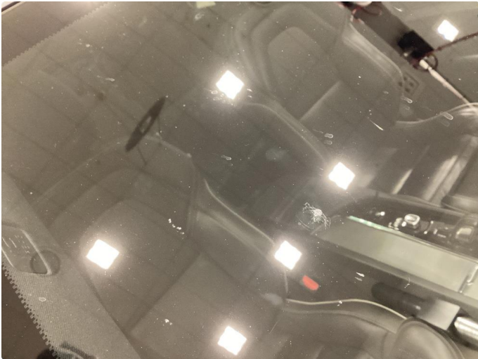
1.1 Steinsprut med sprekk utenfor synsfelt - Ny frontrute
