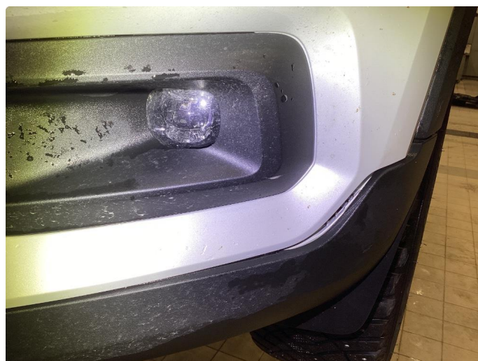
1.4 Underdel løsnet - montert i spor og plass
