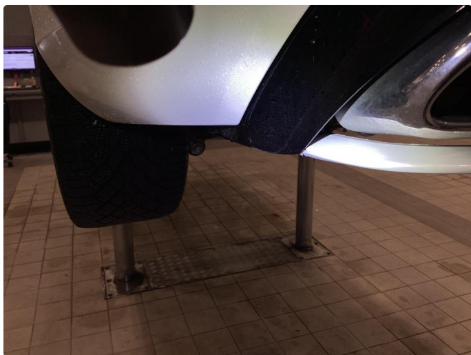
1.5 Flasset noe lakk ved eksos
