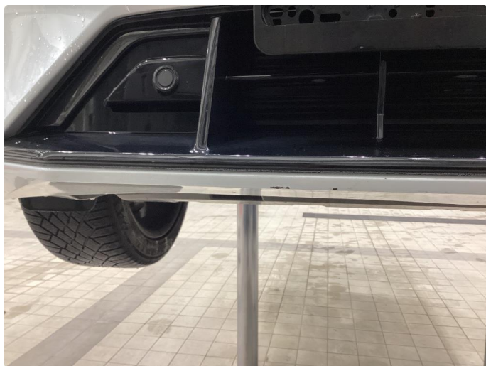
1.6 Skrap i underkant av støtfanger foran
