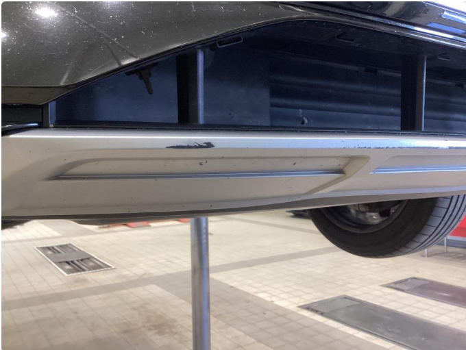
1.2 Skrubbskader underkant - Nedre felt i sølv og støtfanger er lakkert
