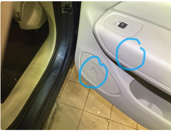
3.1 Skadet/merker etter utstyr - Byttet
