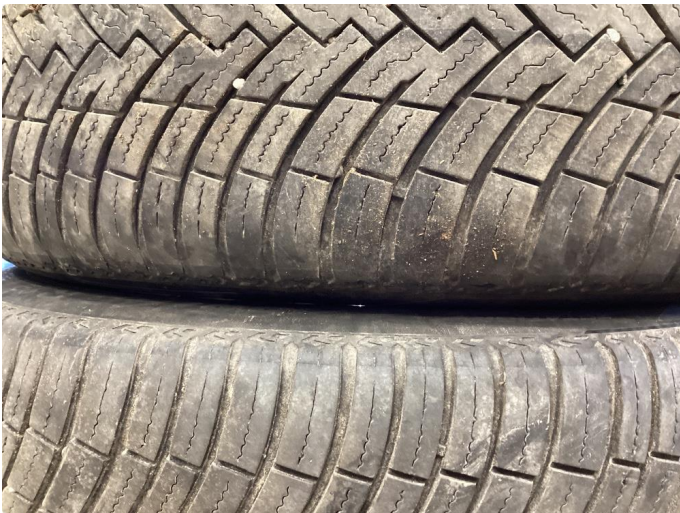
1.2 4-hjullkontroll utført - Bytte dekk pga skjevslitasje
