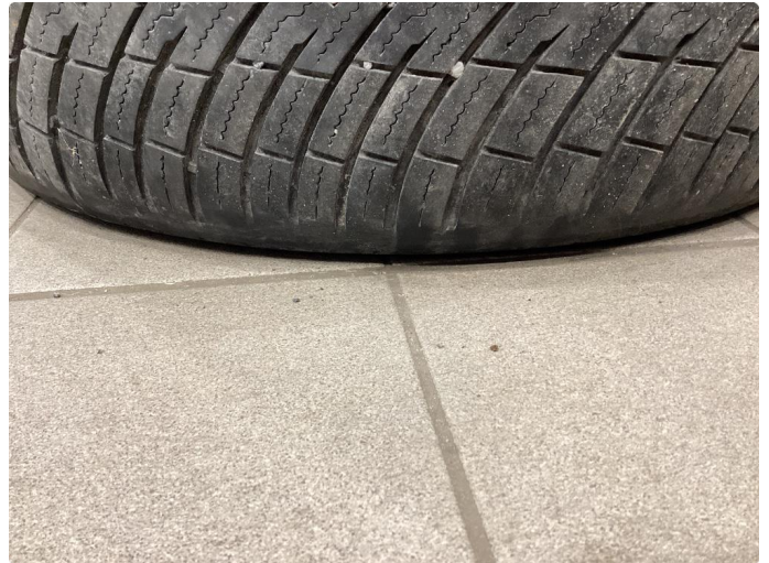
1.2 4-hjullkontroll utført - Bytte dekk pga skjevslitasje
