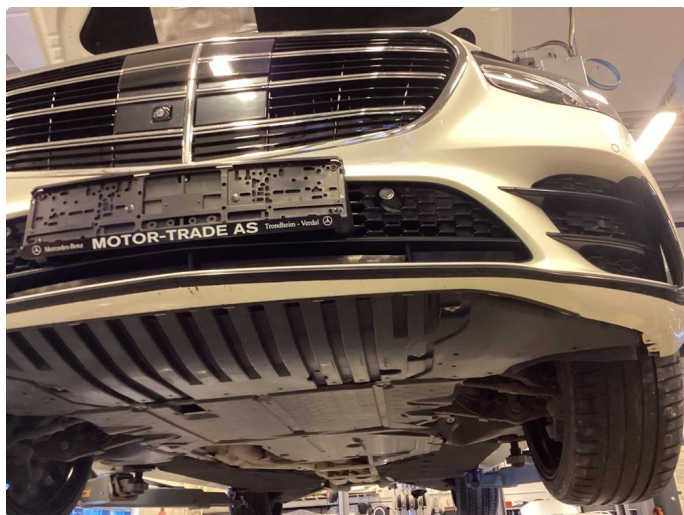
1.3 Små riper i underkant av plastikk på støtfanger
