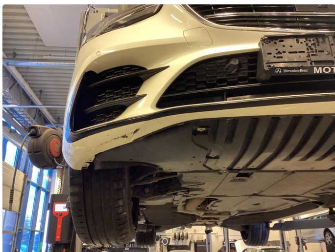
1.3 Riper i underkant av plastikk støtfanger
